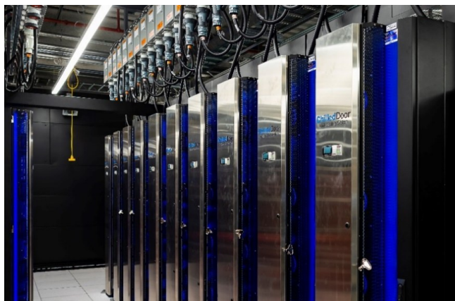
图 2. Frontier 冷却系统的局部图。该系统每分钟可在机器内循环超过 151 000 L 的水，效率比其前身超级计算机 Summit 的冷却系统高出 30%~40%。资料来源：橡树岭国家实验室（CC BY 2.0）。
