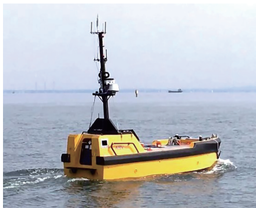
图2 日本海上保安厅在东海使用的无人测量船
