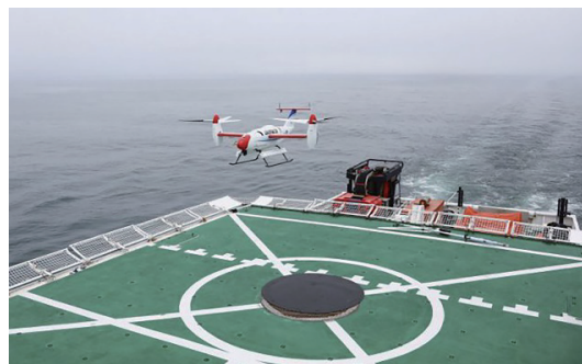
图3 韩国 TR-60 倾转旋翼无人机
