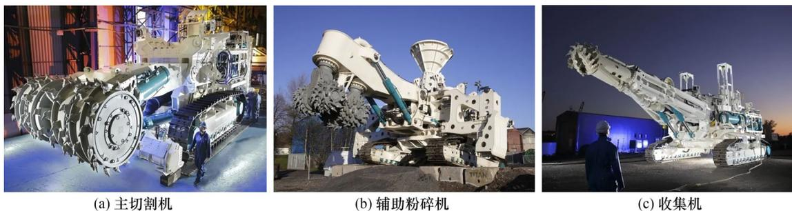
图2 鸚鵡螺公司相关海底采矿设备
