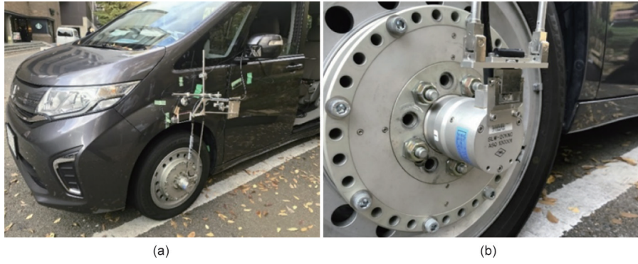
图19. 轮胎力估算的实验装置。(a) 配备的测试车;(b) 轮载传感器[60]。
