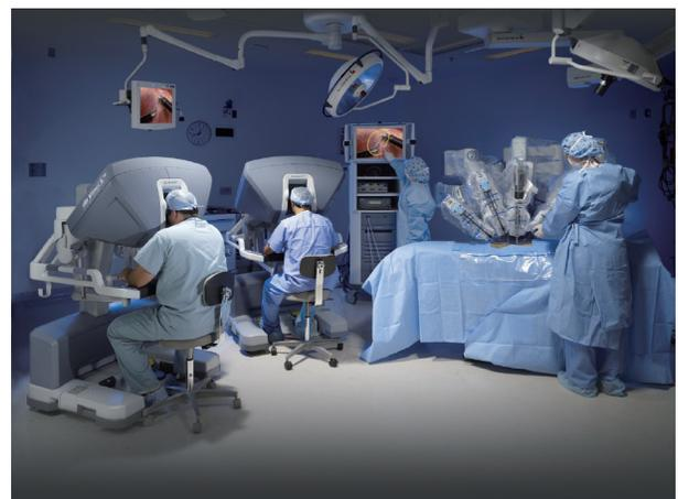
图1. 对用于手术室的da Vinci机器人辅助外科手术系统的模拟。该系统通常包括一个固定有四个机械臂的机器人推车（右），这个推车由外科医生利用专门的控制台（左）进行远程控制。图源：©2016 Intuitive Surgery, Inc.（维基共享资源，CC BY-SA 3.0）。
