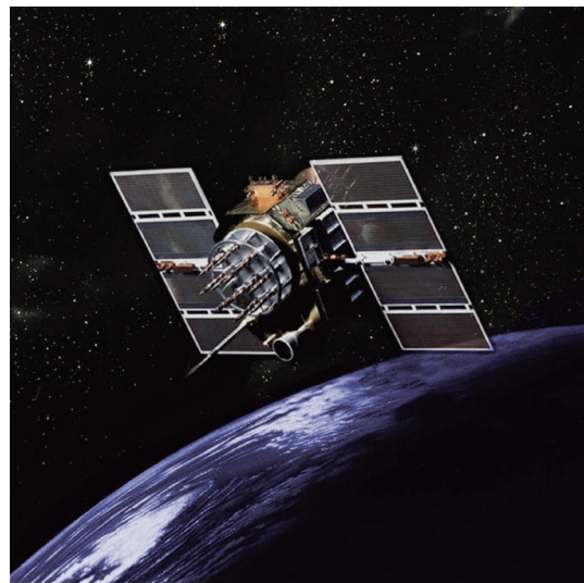
图13. 艺术家绘制的第二代GPS Block IIA卫星图; 这些卫星在1989—1997年发射, 现在都已退役, 最后一颗卫星在2019年退役。目前的GPS星座大部分由最近的第二代GPS卫星系列组成, 截至2020年8月, 太空中仍有29颗(10颗IIR、7颗IIR-M和12颗IIF)在运行。来源: GPS.gov (public domain)。
