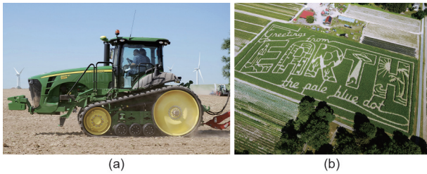
图10。(a)安装在John Deere 8345 RT拖拉机的雨篷前面的Startfire (D) GPS接收机引导卫星辅助转向系统。(b)在精确GPS的指导下, Precision Maxes (Lee's Summit, Mo, USA)在美国马萨诸塞州桑德兰创建了这个玉米迷宫。来源: bdk, Wikimedia Commons (CCBY-SA3.0); Precision Mazes (public domain)。
