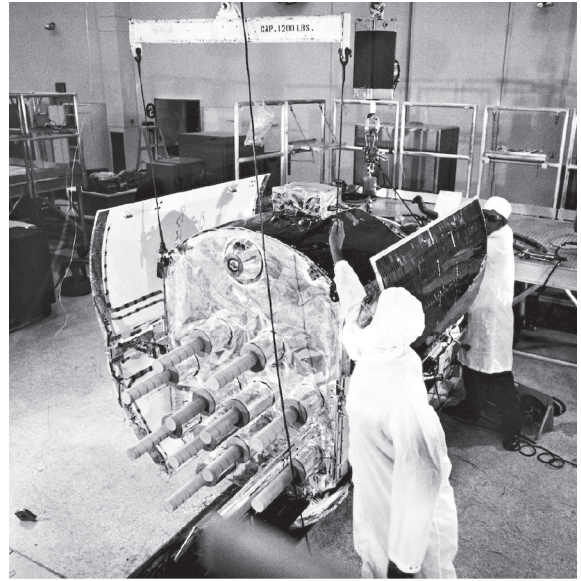
图7. 1978年，工程师在发射前对第三个GPS卫星原型进行了测试。来源：The Aerospace Corporation (public domain)。
