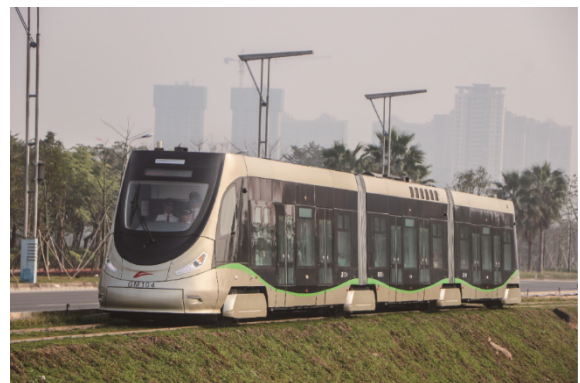
图2. 加拿大Ballard Power Systems公司与中国中车（CRRC）青岛四方机车车辆股份有限公司合作开发的有轨氢能列车目前正在中国唐山市和佛山市运行。来源：Wikimedia Commons（CC BY-SA 4.0）。
