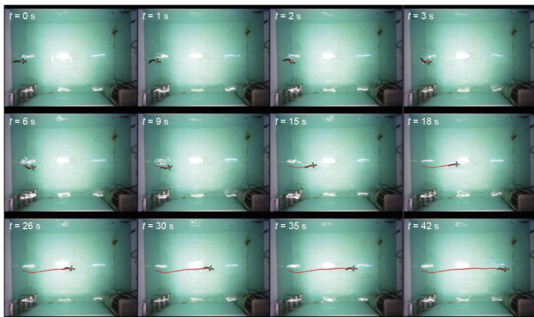
图11. 容错控制下具有一个被卡住尾关节的机器鱼的游动视频截图序列。
