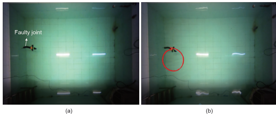
图8. 无控制故障机器鱼游动性能。(a) 初始姿态；(b) 游动轨迹。
