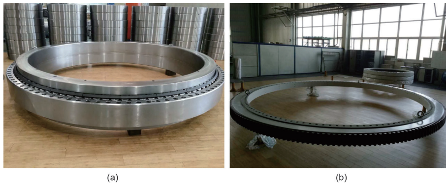
图5. 洛阳LYC轴承有限公司制造的大功率风电机组用主轴轴承 (a) 和偏航轴承 (b)。主轴轴承的外径和内径分别为3200 mm和2620 mm，偏航轴承的外径和内径分别为5107 mm和4420 mm。
