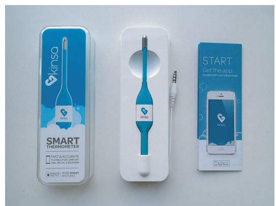
图2. 这款售价30美元的Kinsa智能体温计与一款手机应用程序协同工作，该应用程序可以记录用户体温的历史数据，并将体温数据传给公司，用于流感和类似流感的疾病（包括COVID-19）传播的公共卫生预测。目前正在使用的100多万个Kinsa体温计的读数，使Kinsa公司能够建立全美的发热基线水平。公众可以在该公司网站上看到健康气象图，该图显示了哪些地区的发热程度高于预期水平（这可能预示着新冠病毒的暴发）。例如，2020年3月31日的气象图显示，纽约地区的发热程度有所上升，该地区COVID-19病例数激增。来源：Wikimedia Commons (CC BY 2.0)。
