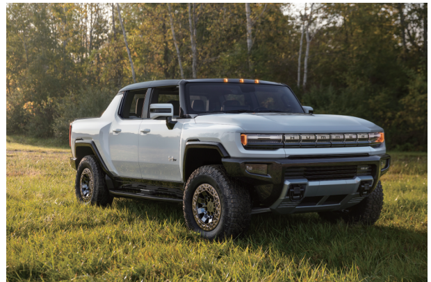
图2. 2022款悍马电动SUT将成为首款采用通用汽车新型无线BMS的电动汽车。该系统控制的200 kW·h电池组的输出电压为400 V，可通过功率高达350 kW、输出电压为800 V的充电器充电。该电池组由24个电池模块组成，分为两层，是第一代Ultium电池组中功率最大的（最大功率为746 kW）。通用汽车还宣布将于2023年秋季推出2024款悍马电动SUV，其峰值功率（619 kW）比2022款悍马电动SUT的小约20%。资料来源：GM (public domain)。
