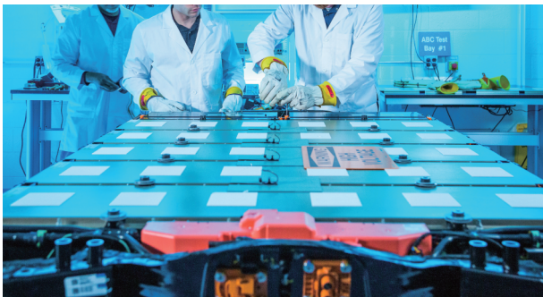
图1. 2020年2月，通用汽车电池电学实验室中表面整洁的高压电动汽车电池组盖板下，多个电池模块包裹着紧密封装的电化学电池。这些模块之间可进行无线通信，还可以与由通用汽车和电子元件制造商ADI共同开发的微处理器的电池监控系统进行通信。资料来源：Jeffrey Sauger/GM (public domain)。
