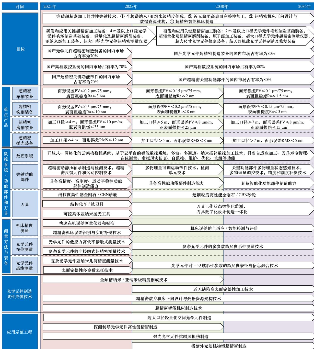
图1 高端光学元件超精密加工技术及装备发展路线图
