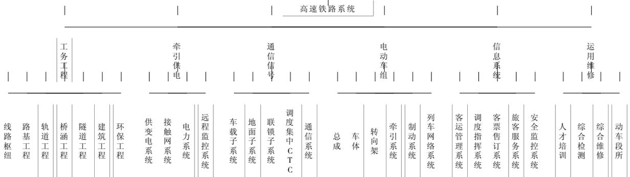
图3 高速铁路系统构成
