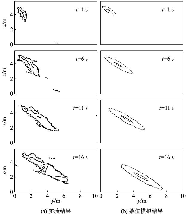
图 7 工况 5 污染物分布范围的数值模拟结果和实验结果比较
