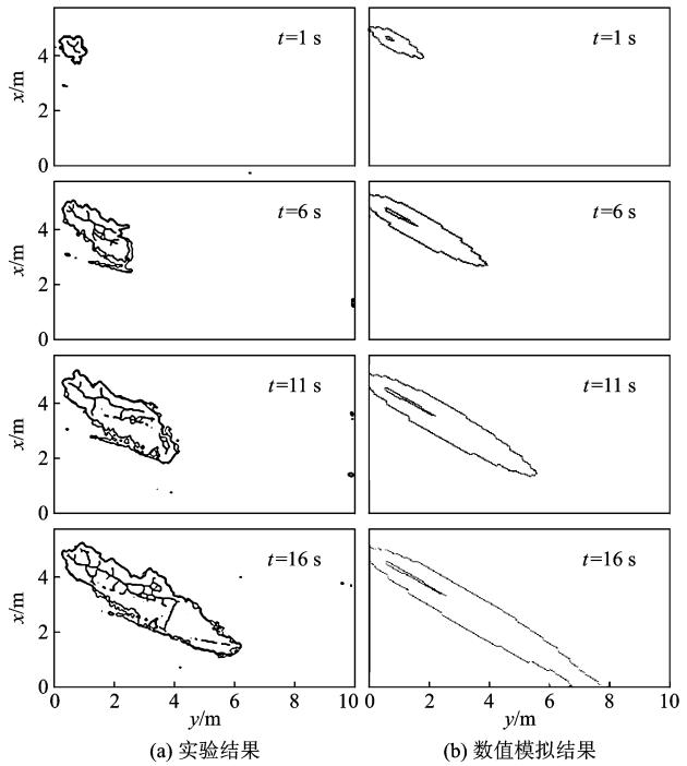
图 5 工况 3 污染物分布范围的数值模拟结果和实验结果比较
