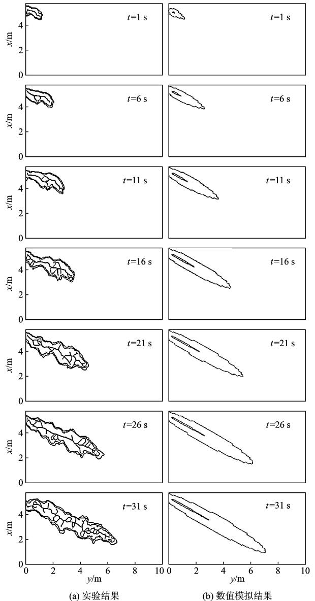
图 8 工况 6 污染物分布范围的数值模拟结果和实验结果比较
