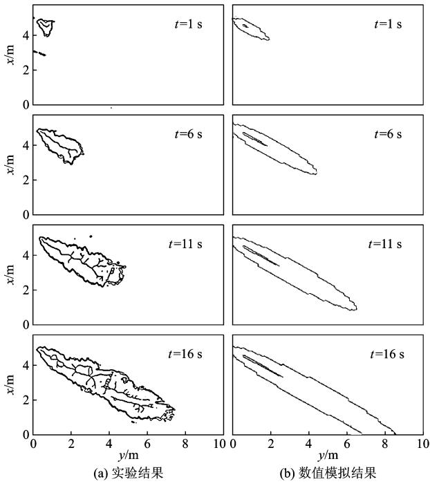
图 6 工况 4 污染物分布范围的数值模拟结果和实验结果比较
