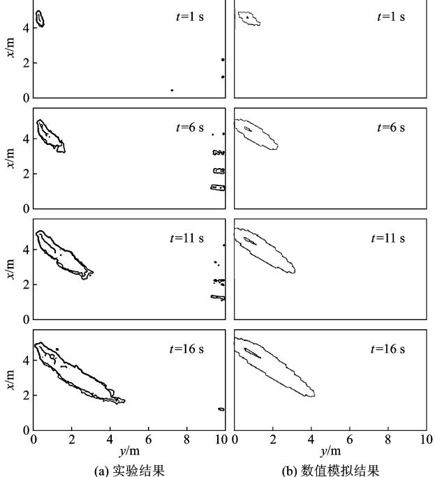
图 3 工况 1 污染物分布范围的数值模拟结果和实验结果比较
