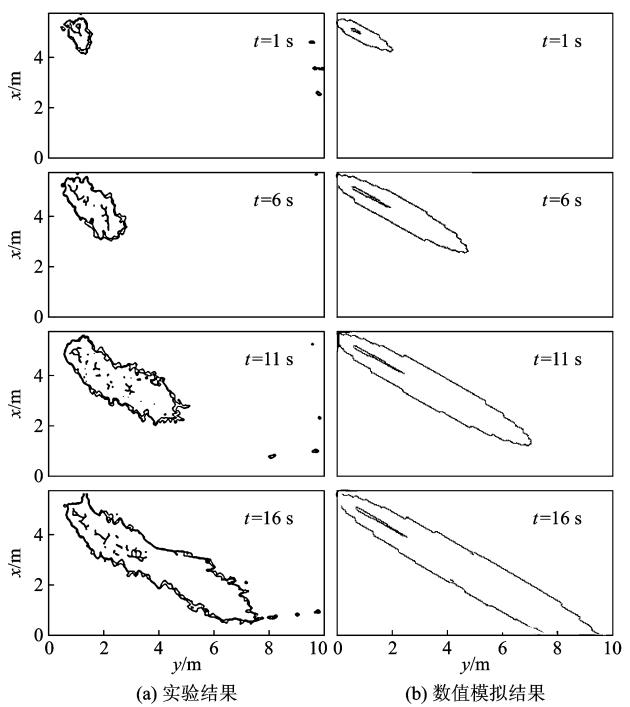
图 4 工况 2 污染物分布范围的数值模拟结果和实验结果比较
