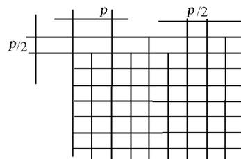
图 1 错半个像元的两帧图像的空间结构图
