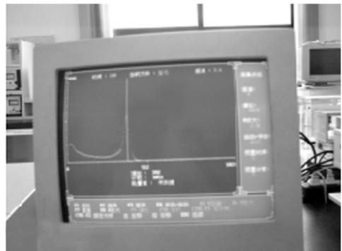
图 5 在 633 Gs 下进入铜狭缝的  $\beta^-$  粒子能量为 1.406MeV
