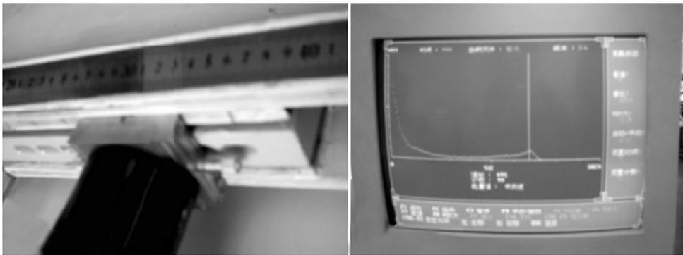
图6 在 800 Gs 下进入铜狭缝的  $\beta^-$  粒子能量为 1.998 MeV
