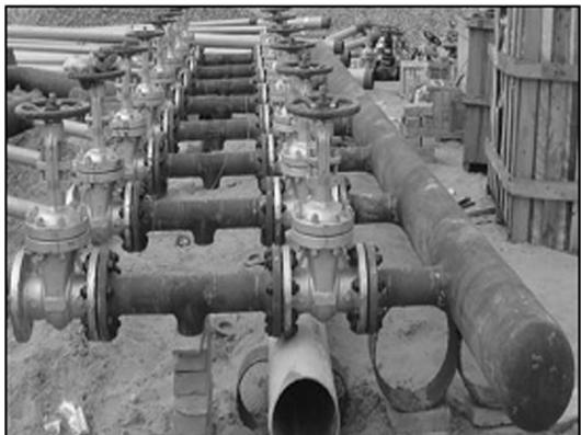
图3 总机关预制模块
