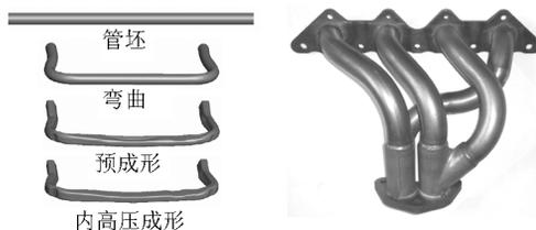
图 11 发动机副车架液压成形过程和排气歧管
