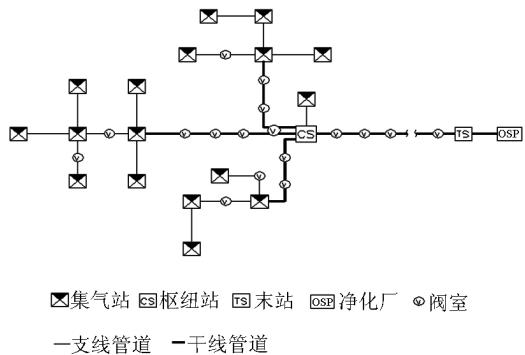
图 2 单管输送流程示意图
