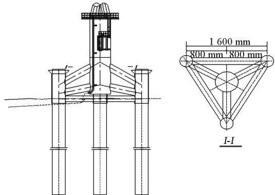
图2 三桩基础示意图
