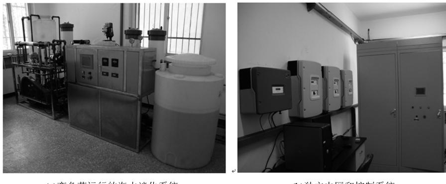
图 6 独立风电 - 海水淡化试验模拟系统
