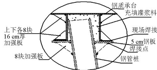
图1 承台/钢管桩连接示意图
