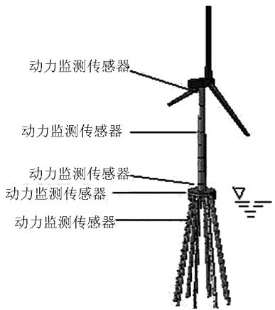
图 4 响水风机振动测试点布置示意图
