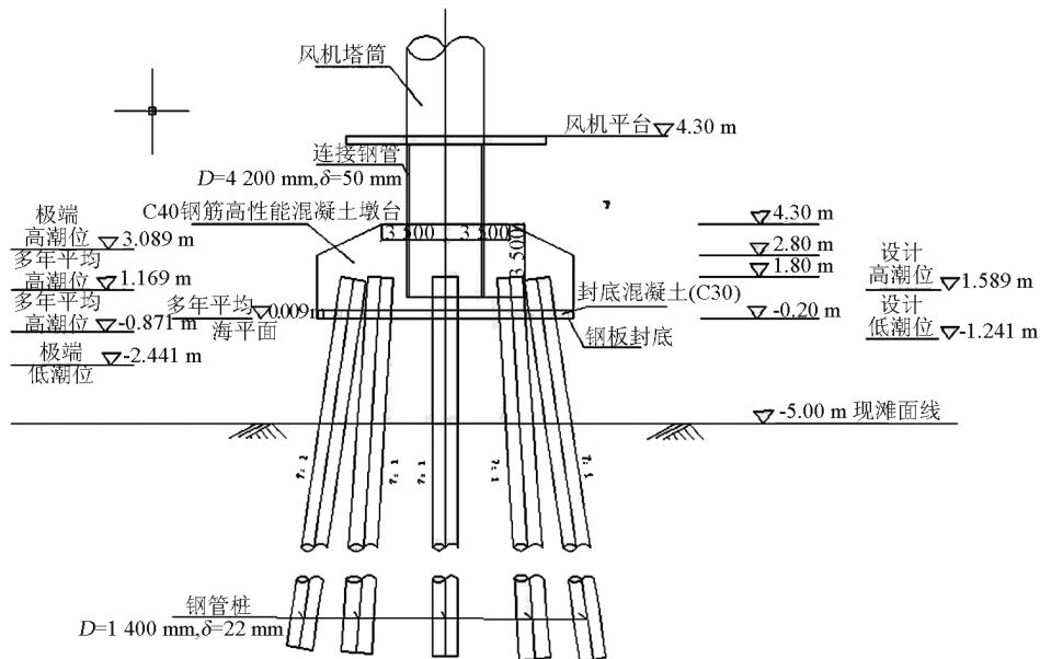
图3 群桩基础示意图
