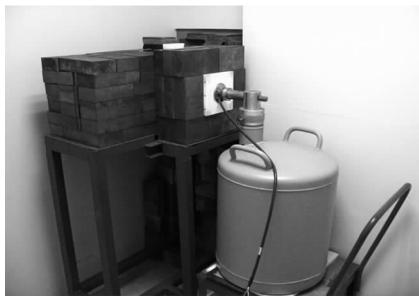
图 2 按初步设计方案搭建的 PGNAA 屏蔽系统照片
