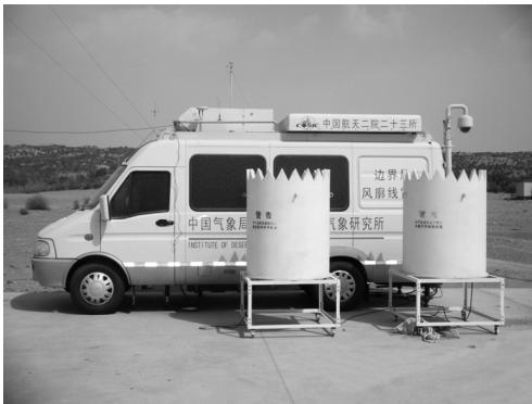
图 2 CFL - 03 车载移动风廓线雷达在塔克拉玛干沙漠大气环境观测试验站观测沙尘暴
