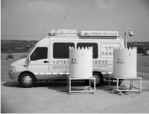
图 2 CFL-03 车载移动风廓线雷达在塔克拉玛干沙漠大气环境观测试验站观测沙尘暴
