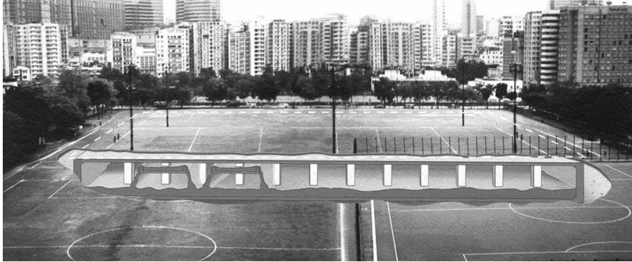
图 4 “跑马地”跑马场下的蓄洪池
