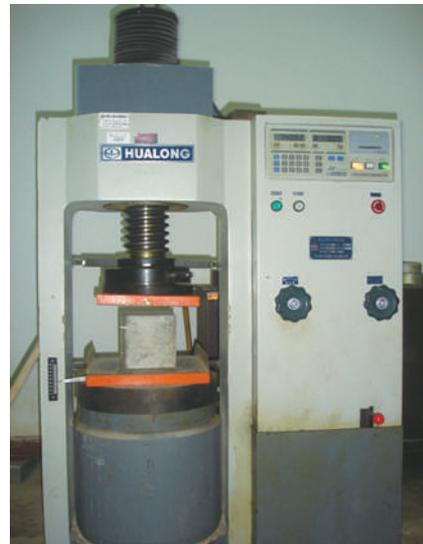
图2 抗压试验装置
