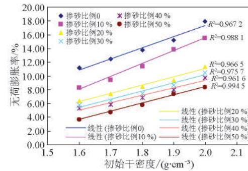
图5 改良膨胀土无荷膨胀率与初始干密度之间的拟合关系曲线
