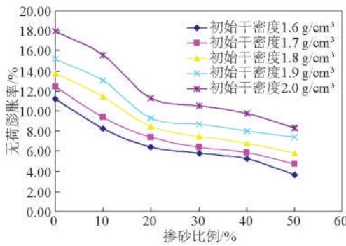
图3 无荷膨胀率与掺砂比例之间的关系曲线
