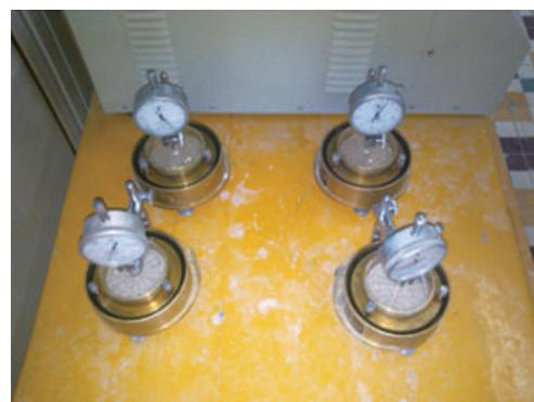
图 1 无荷膨胀率试验
