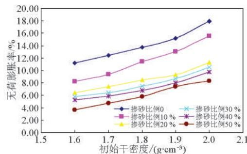
图4 风化砂改良膨胀土无荷膨胀率与初始干密度之间的关系曲线
