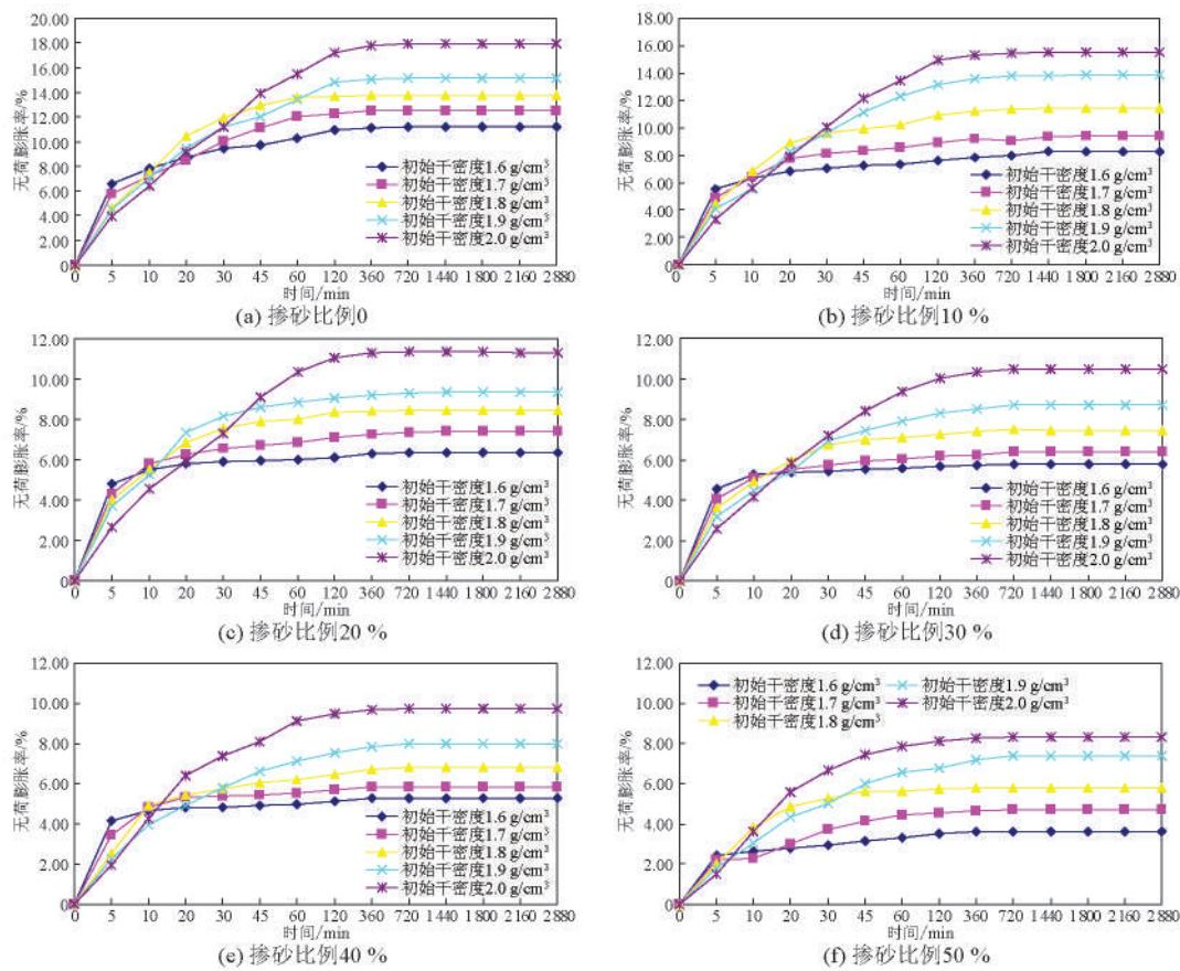
**图2 无荷膨胀率与时间的关系曲线**
