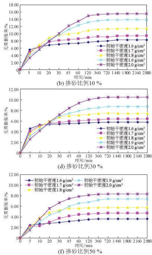
膨胀率与时间的关系曲线基本水平,表明此阶段的膨胀率基本保持不变,膨胀变形达到稳定。这是由于此阶段膨胀土试样已经吸水饱和,试样中的土颗粒已经膨胀完全,使此阶段的膨胀率基本保持不变。
