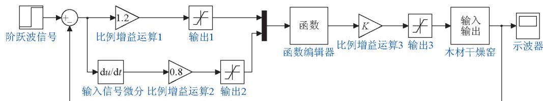
图5 木材干燥模糊神经网络控制器仿真模型
