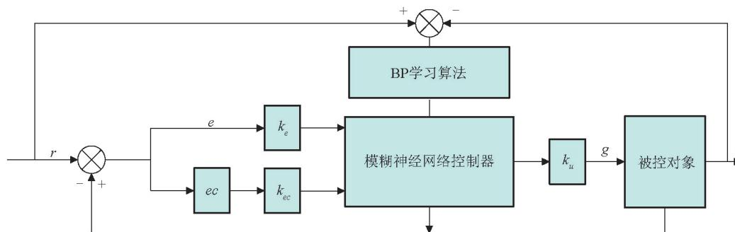
图 2 木材干燥模糊神经网络控制系统方框图
