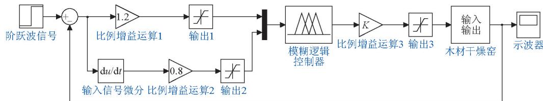
图3 木材干燥模糊控制器仿真模型
