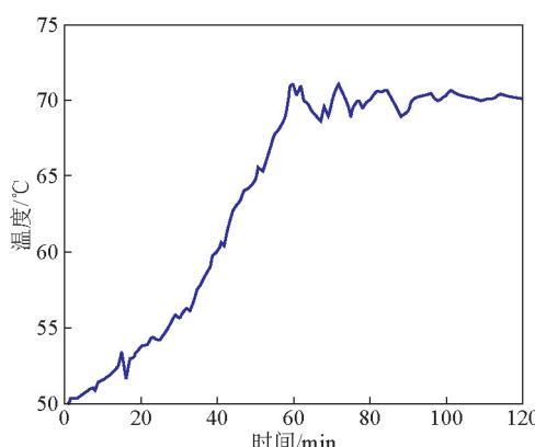
**图6 模糊神经网络控制系统温度输出曲线**
