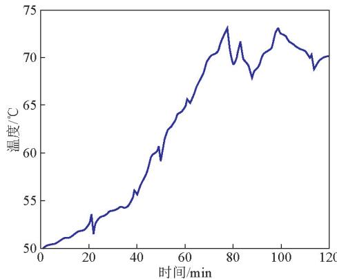
图4 模糊控制系统温度输出曲线
