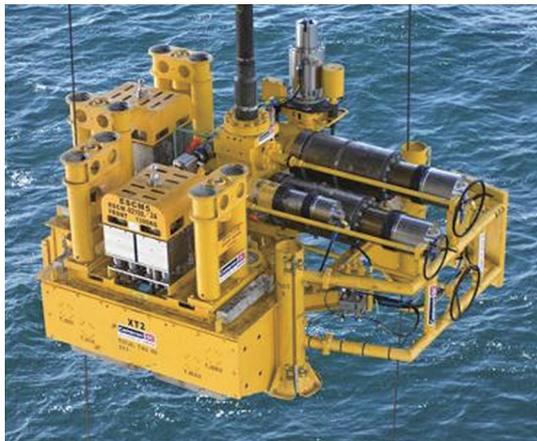
图3 全电控制采油树(由 OneSubsea 提供)
