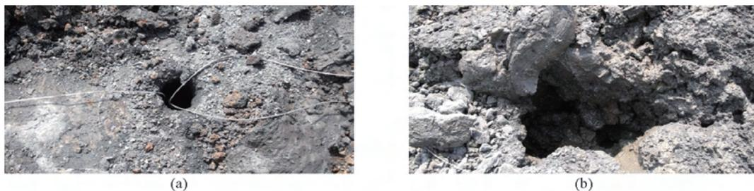
图2 软弱夹层导致的冲炮
