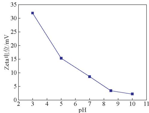
图8 BHAC-PIP 纳滤膜在不同pH下的Zeta电位值
