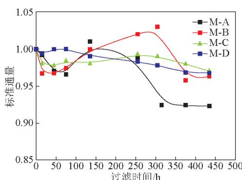
图6 基于BPAC反渗透复合膜的抗污染性能, BPAC含量依次为0(M-A), 0.04%(M-B), 0.07%(M-C), 0.1%(M-D)
