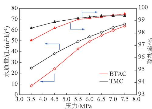
图5 不同压力条件下BTAC复合膜与TMC复合膜性能比较
