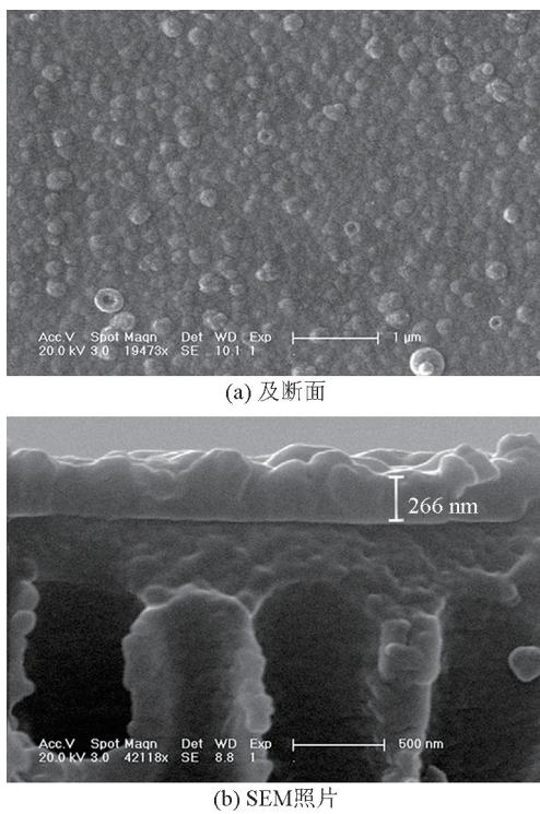
图7 BHAC-PIP 纳滤复合膜的表面
