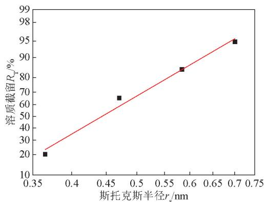
图9 BHAC-PIP 纳滤膜在对数-概率坐标系中的中性有机分子截留曲线
