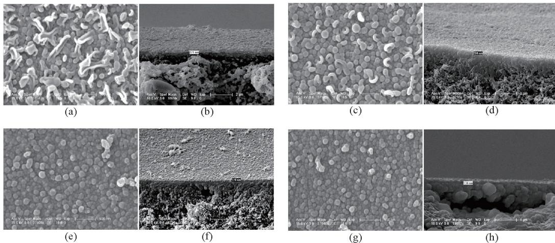
图2 不同官能度酰氯单体反渗透复合膜的SEM照片
