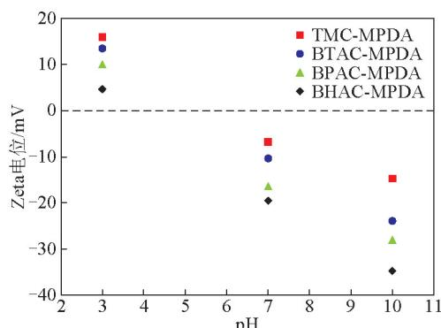
**图 4 不同官能度酰氯单体反渗透复合膜的 Zeta 电位**
