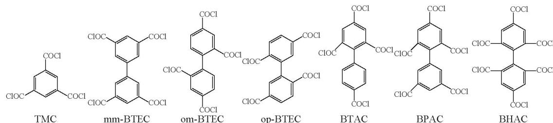
图1 多元酰氯的结构示意图<sup>[8,9]</sup>
