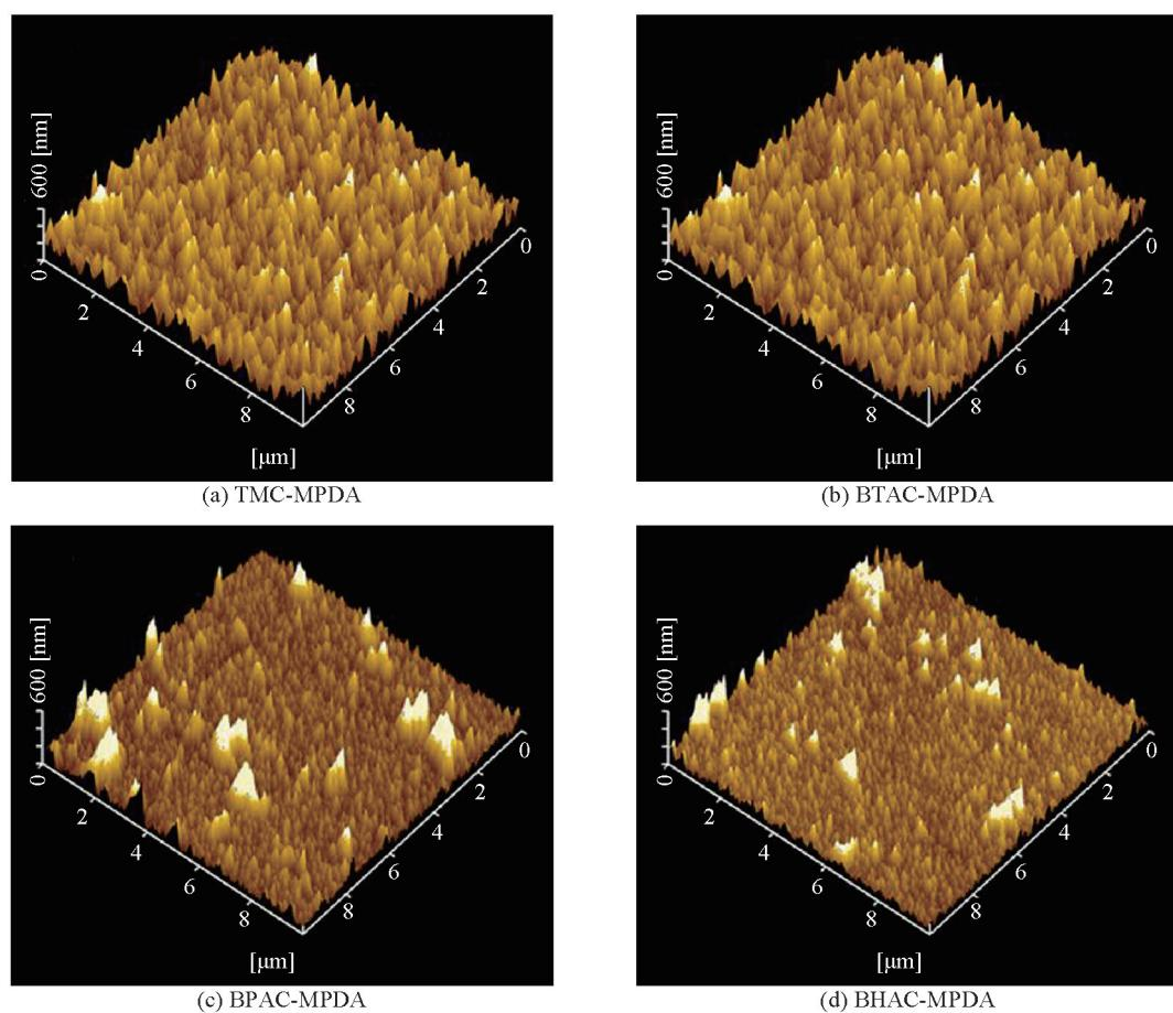
图3 不同官能度酰氯单体反渗透复合膜的AFM照片
