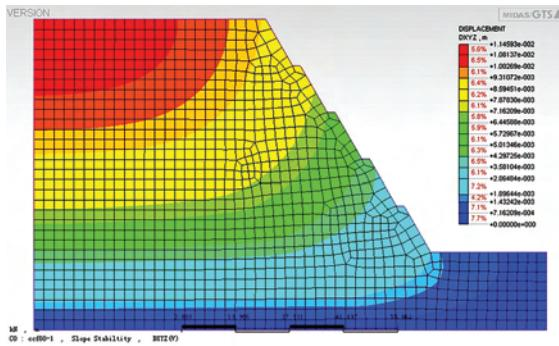
图2 边坡位移( $\alpha=60^\circ$ )
