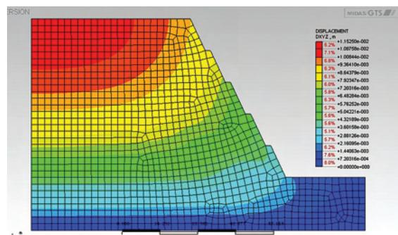
图1 边坡位移 ( $\alpha=65^\circ$ )
