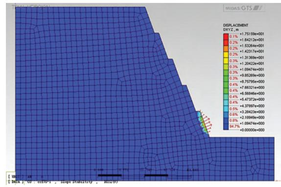
图5 边坡位移( $\alpha=70^\circ$ )
