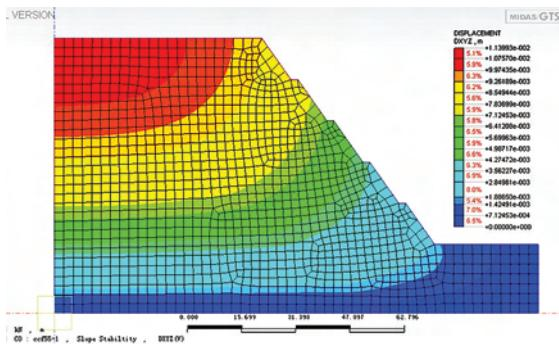
图3 边坡位移( $\alpha=55^\circ$ )
