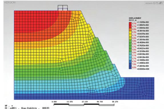
图6 桥基压力对边坡位移的影响
