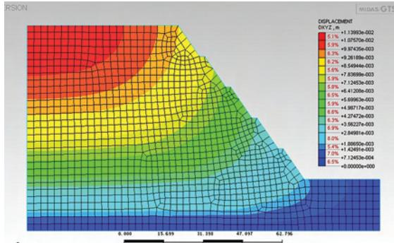
图4 边坡位移( $\alpha=50^\circ$ )
