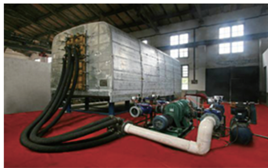
图6 交变气动载荷实验装置
