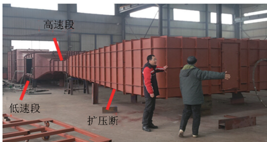
图8 风沙、风雨及风速传感器检定实验装置
