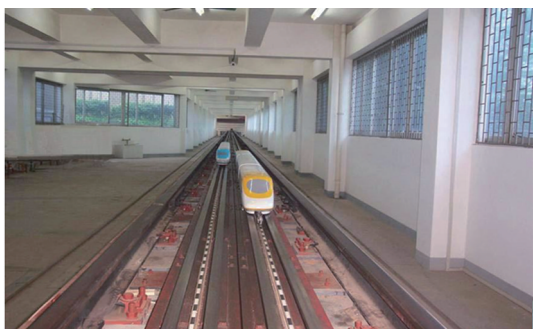
图5 高速列车气动特性动模型实验系统
