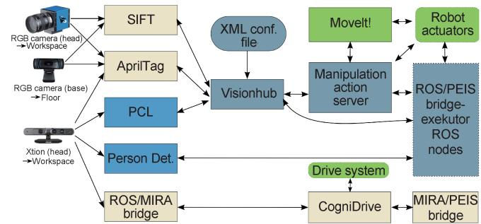
图 8. 多模态感知系统总体结构。RGB 摄像头的数据传递至 SIFT 物品识别模块以及基于二维码的物品识别模块中。XtionPro 的 RGB-D 图像及点云信息经 PCL 进行处理，利用 ROS 中的 tabletop\_object\_recognition 软件包进行物品的识别和抓取位姿的计算。不同识别模块的结果汇总至 Visionhub 节点中进行数据融合，最终输出所识别的物品序列、位姿信息以及相应的自相关性估计值。点云信息还用来进行人的识别以及移动平台导航定位过程中的避障。
