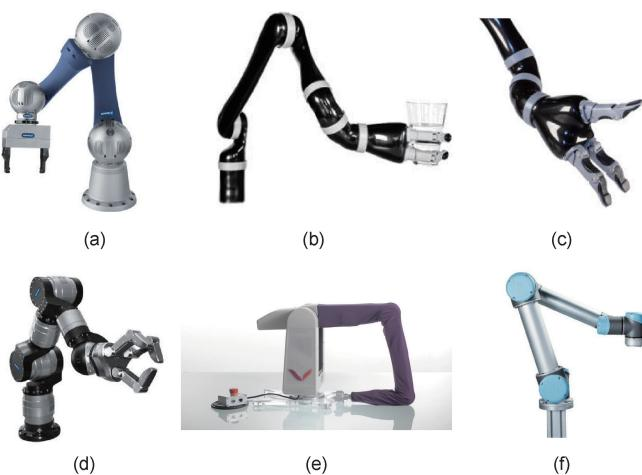
图 4. 对室内服务机器人所用机器臂的选择需要考虑的因素包括重量、负载能力、工作空间范围、是否易于安装于移动平台和成本等。(a) Schunk Powerball; (b) Kinova Jaco; (c) Jaco 三指灵巧手（伸展状态）；(d) Schunk 模块化臂；(e) BioRob；(f) UR5。
