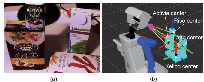
图 9. 对随机摆放的桌面物品进行识别。(a) 机器人头部摄像头视野中显示的摆放在桌子上的若干盒装物品；(b) 通过 ROS Rviz 可视化工具显示出的物品识别结果。每一个被检测到的物品的名称、形状以及物品的 6 自由度位姿信息（3 位置，3 姿态参数）通过 ROS 中 message 的形式发布出来。在该图场景中，全部 4 个盒装物品通过 Visionhub 节点准确地检测、计算并发布出来，通过 Rviz 显示它们的形状（包围盒）以及空间位姿（图中红、绿、蓝轴构成的空间坐标系）等信息。
