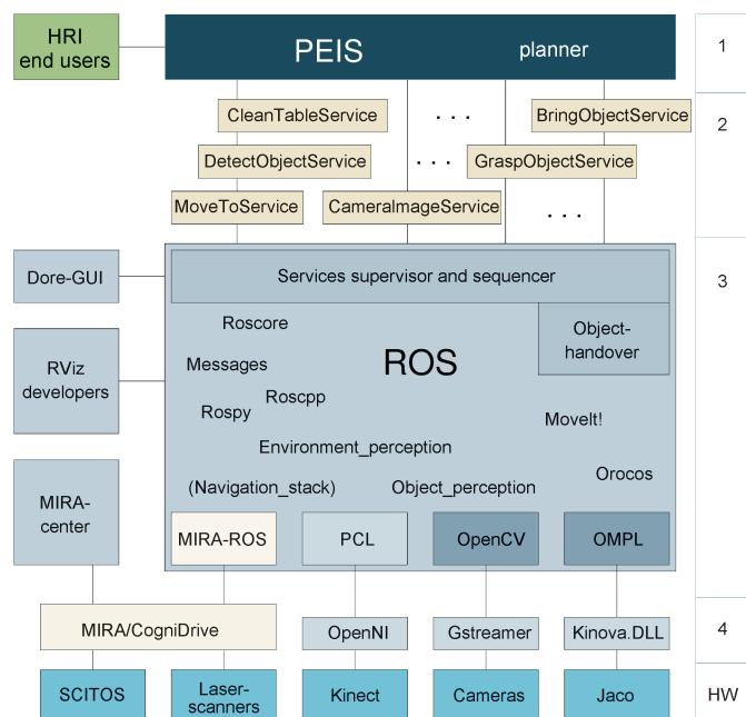
图 6. 室内服务机器人软件架构。用户通过语音或触摸屏（人机界面）向 PEIS 发送指令。PEIS 对传感器网络进行管理，并提供符号化任务规划器。PEIS-ROS 中间层中 *executor* 模块将机器人的低、中、高级功能封装为相应的服务（第 2 层）。机器人的核心软件层（第 3 层）基于 ROS 构建，其中的导航定位模块使用了 MIRA/CogniDrive 软件包。第 4 层中包括了所有传感器、执行器等硬件设备的驱动软件接口。
