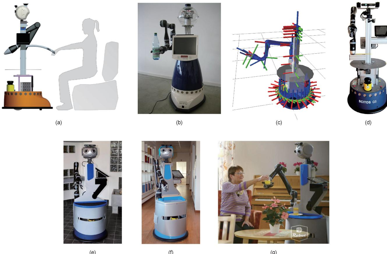
图 3. Robot-Era 项目中室内服务机器人各代样机原型及改进机型。(a) 带助行扶手的原始概念样机设计; (b) 基于 Jaco 轻型臂及 Astromobile 移动平台的机器人样机 [18]; (c) 机器人执行器及传感器坐标系统 (ROS 仿真环境); (d) 项目第一年样机 (无外观包装); (e) 第二年样机 (有外观包装); (f) 第三年样机 (硬件升级及外观包装); (g) 实验测试场景。
