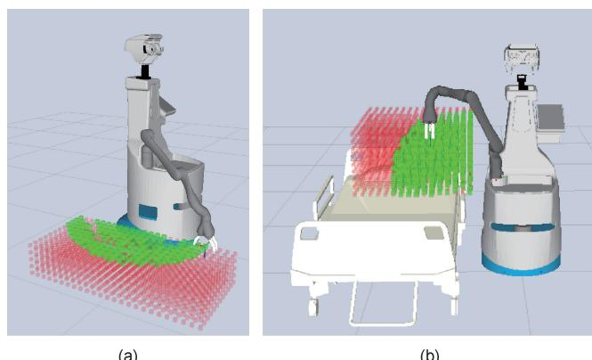
图 5. 机器人 Jaco 机器臂工作空间分析实例（均以顶端抓取姿态为例）。手臂安装在机器人右侧，因此能够同时覆盖机器人右侧较大的工作空间，包括机器人右侧的地面以及机器人上的置物托盘。(a) 机器人右侧地面工作空间覆盖范围；(b) 医院护理场景工作空间覆盖范围。
