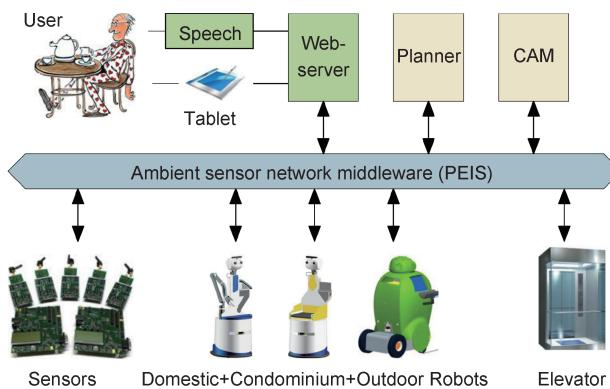
**图 2. Robot-Era 项目总体架构。** 用户通过语音界面或者平板触摸屏图形界面与系统进行交互。不同的场景采用不同的机器人，如室内服务机器人、楼内转运机器人以及室外搬运机器人。PEIS 中间层对环境感知信息、用户操控数据、机器人信息和智能家电的数据进行整合。规划器用来协调智能环境系统和服务机器人。
