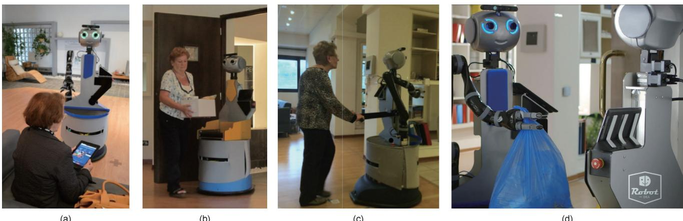
图 11. 第一次实验场景图。(a) 触摸屏界面; (b) 公寓内转运机器人; (c) 室内行走辅助; (d) 室内服务机器人和转运机器人交接垃圾袋。
