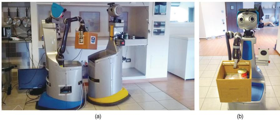
图 10. 服务机器人与转运机器人之间的物品传送。(a) 盒子上安装了 AprilTag 二维码标签; (b) 盒子内的圆形把手提高了 Jaco 机器臂的抓取稳定性。
