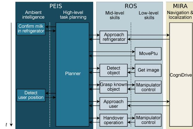
图7. 获取物品服务的运行时序图示例。当获取到用户的指令（“取牛奶过来”）后，规划器首先通过CAM模块确定目标对象的位置，进行任务规划并调用服务机器人的相关服务。在此示例中，机器人的移动过程（移动至冰箱位置，从冰箱位置返回用户位置）由MIRA/CogniDrive模块处理，其他的感知、机器臂动作规划和执行等由ROS中其他节点处理。
