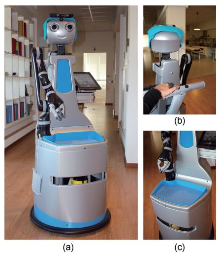
**图 1. Robot-Era 家用机器人。**(a) 该机器人配置了 Scitos-G5 差分移动平台，Kinova Jaco 6 自由度机器臂及三指灵巧手，倾覆传感器（pan-tilt sensor）；(b) 辅助用户行走的倾斜手柄；(c) 物体搬运托盘。
