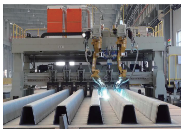
(a) U形肋板单元自动组装定位机床
