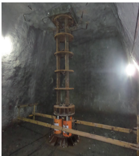
图2. 茨哈峡平洞应力路径试验装置。
