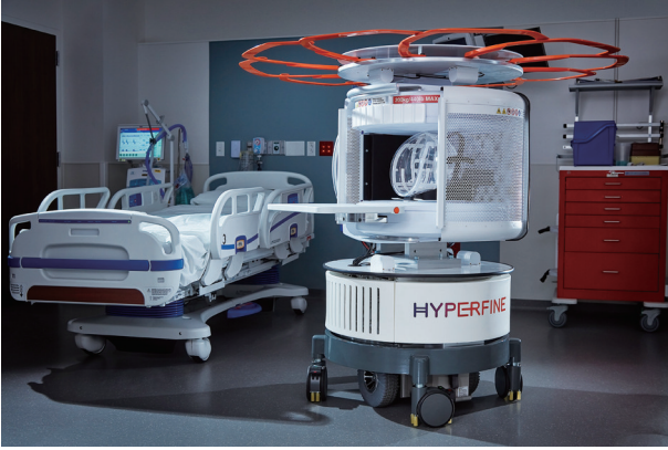
图2. Hyperfine 公司的超低场 MRI 扫描仪用于大脑成像。患者头部从开口合适位置伸入，放置于透明的塑料支架（也称为头部线圈）中，以探测病人头部组织发出的射频能量。该扫描仪顶部的红色物体是高斯保护装置，用于标记磁场边界，边界以外区域不会吸引金属物体或干扰起搏器。来源：Hyperfine（公共领域）。
