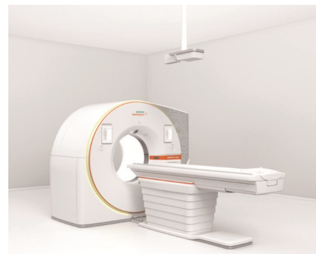
图1. 西门子的NAEOTOM Alpha是首台获监管机构批准的商业PCD CT扫描仪。该设备具有两个使用碲化镉晶体材料的探测器，空间分辨率可达到0.11 mm。该扫描仪的两个X射线管提供的时间分辨率可降低至66 ms，使其更容易为跳动的心脏成像。来源：Siemens（公共领域）。
