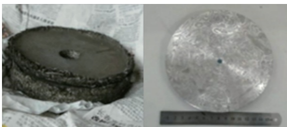
图 8 C_f/Mg 复合材料圆盘样件（高速离心试验后）
