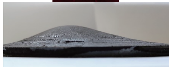
图 7 梯度 B_4C/Al 复合材料弹击后靶板及钢背板
