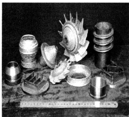
图 15 镍基高温合金激光快速成形试验件
