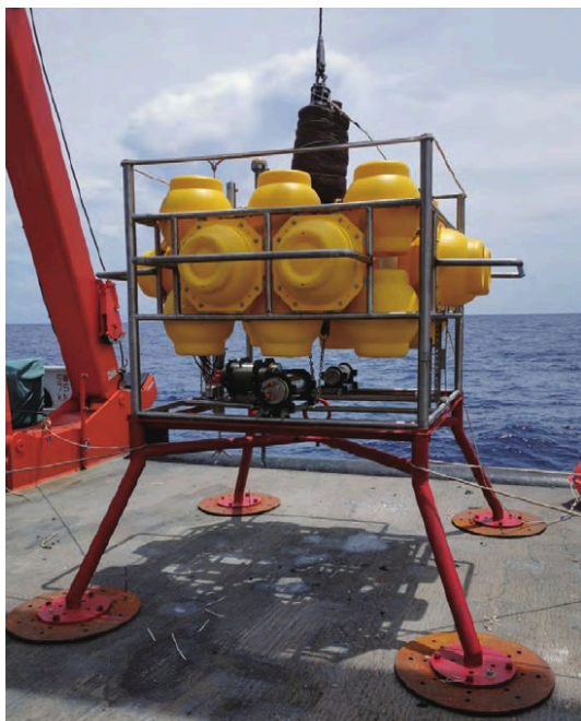
图5 中国海洋大学深海海底边界层原位观测系统
