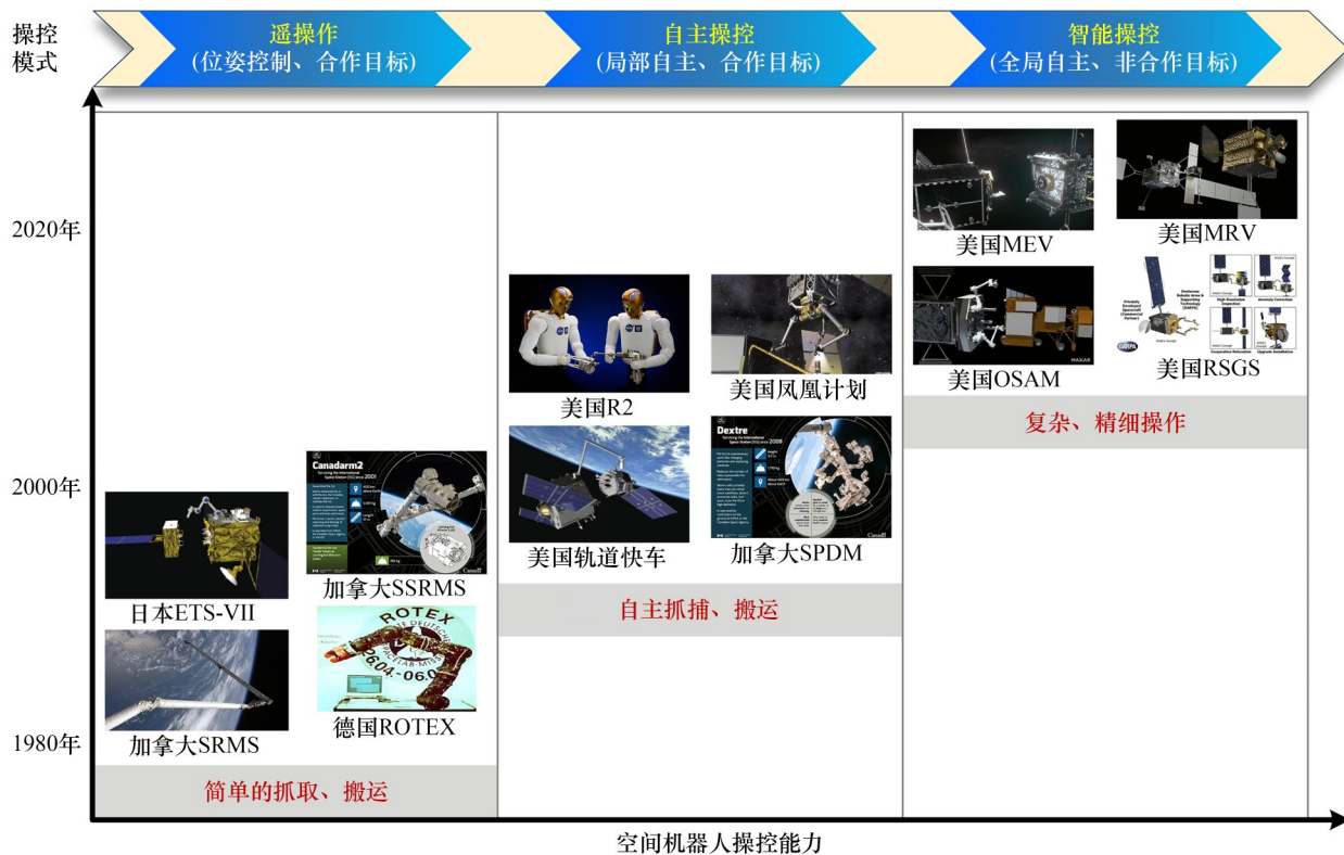
图1 空间机器人操控能力的发展过程与发展方向
