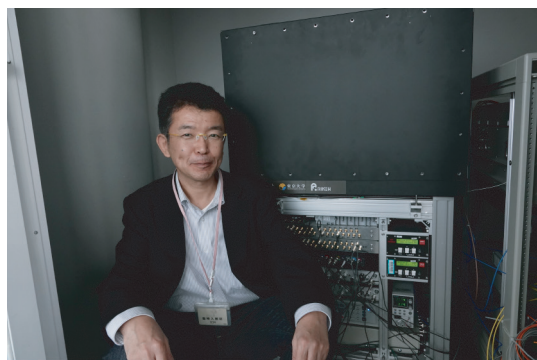
图1. Katori教授蹲坐在两个可移动的光学晶格原子钟之一的旁边，图中的这个位于东京晴空塔顶部的原子钟（见图2），另一个在塔底部。这个塔利用时钟的能力来测量秒（精确到小数点后18位），这项实验测试了阿尔伯特·爱因斯坦对时间膨胀的预测，该原子钟是有史以来最精确的地面时钟[2]。东京大学的Katori和他的同事制造的每一个可移动时钟都由三个盒子组成，总体积约为 1\text{ m}^3 。图片来源：由Katori提供。
