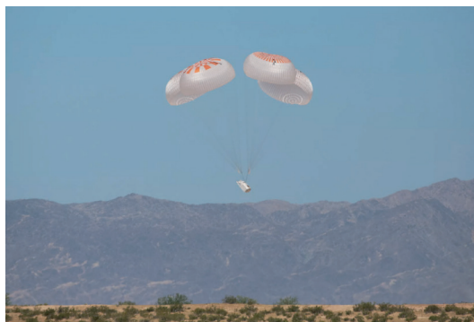
图3. 测试结果显示，“龙飞船”使用四件式降落伞系统将太空舱轻轻带回地球。来源：SpaceX（公共领域）。
