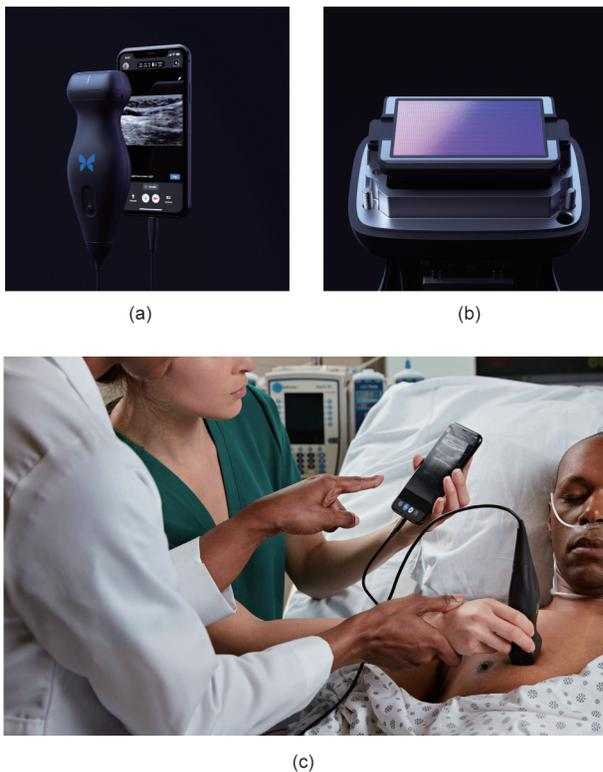
图2. (a) Butterfly Network 公司的 iQ+ 超声系统为有线手持设备, 即通过数据线与手机连接。(b) 设备的一端包含产生超声波的硅芯片, 其中 9000 个微型传感器组成了一个二维阵列 (移除探测器顶部外壳后可见)。该技术使得设备在同一端可进行线性和弧形探测。(c) 外科医生使用 iQ+ 对患者进行检测。来源: Butterfly Network 公司授权。
