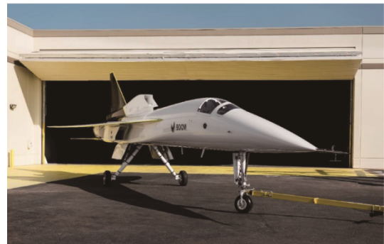
图1. 于2020年10月公开亮相的Boom超声速公司的XB-1原型机,大小为计划生产的“Overture”商用超声速客机的三分之一。来源: Boom Supersonic(公共来源)。
