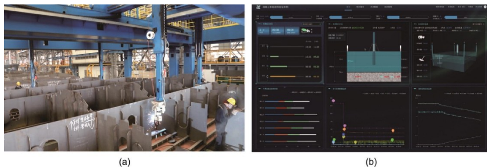
图7. 深中通道沉管工厂化生产采用的智能化生产线 (a) 与智能化质量控制系统 (b)。
