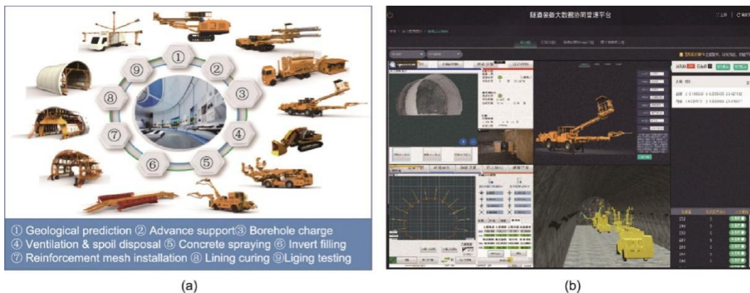
图5. 中国铁建重工集团股份有限公司研发的系列化隧道智能施工装备(a)与协同管理平台(b)。
