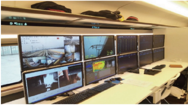
图11. 复兴号动车组试验监测系统。
