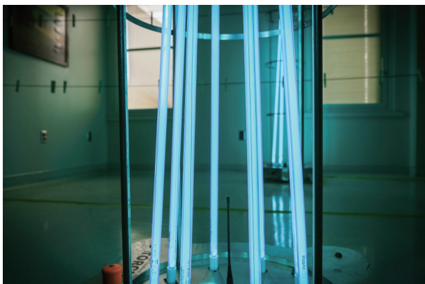
图3. 美国内布拉斯加州大学医疗中心使用紫外线对N95口罩进行消毒，供医务人员重复使用[9]。使用过的口罩挂在两个紫外线组成的辐射塔之间的晾衣绳上，每个辐射塔有8根紫外灯管；经紫外线辐射15 min处理，可以杀死病毒，且单批次可处理90个口罩。来源：内布拉斯加州大学，经许可。
