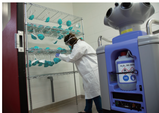
图4. 使用Bioquell公司（位于宾夕法尼亚州霍尔沙姆市）的过氧化氢蒸气发生器，杜克大学医院的工作人员每批次可对1250个口罩进行消毒净化，每12 h可消毒净化2500个口罩，以供重复使用[1]。Battelle（位于俄亥俄州哥伦布市）制造和运营的放大版本的口罩消毒净化系统，每天可以对8万个口罩进行消毒净化处理，足够供应多家医院及医院系统的口罩重复使用[10]。来源：杜克大学，经许可。
