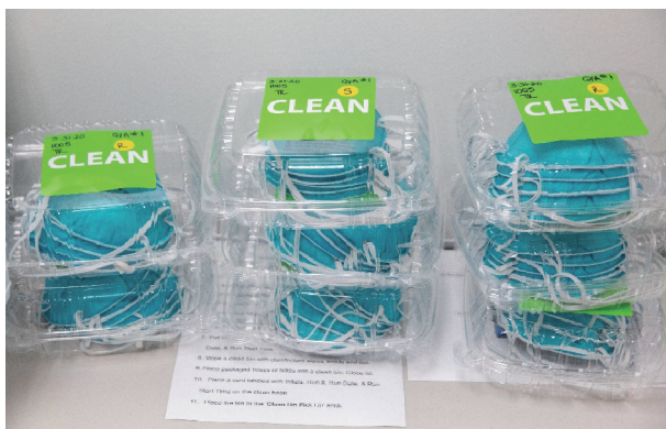
图1. N95口罩,如图中所示的“干净”口罩,使用Bioquell (Horsham, Pennsylvania) Z-2设备(见图2)经过过氧化氢蒸汽消毒净化处理后,在杜克大学医院(Durham, North Carolina)重复使用[1]。来源:杜克大学,经许可。
