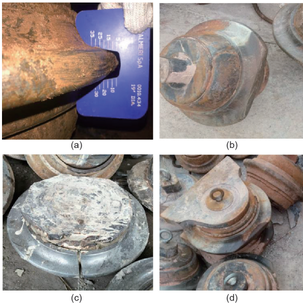
图6. 滚刀磨损。(a) 正常磨损；(b) 偏磨磨损；(c) 刀圈崩坏；(d) 严重损坏。
