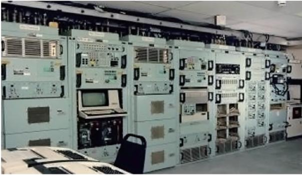
图1. 美国国防部如今还在使用20世纪70年代的IBM系列/1计算机来控制国家的核军火库。直到2019年, 该计算机仍在使用8 in软盘。来源: US GAO (公开)。
