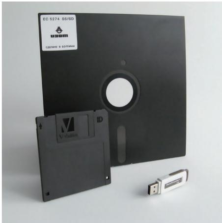
图2. 8 in软盘(后)目前已成为落后技术, 其在1971年商业化应用时是信息存储方面的一个突破, 可存储80 kb的数据。到了20世纪80年代, 其被3.5 in软盘(左)所替代, 而这种软盘现在也已经落后, 取而代之的是通用串行总线(USB)数据密钥(右下角), 这种数据密钥目前可存储数千兆字节的数据。来源: Wikimedia (公开)。
