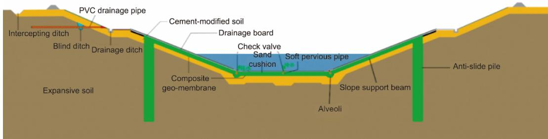
图7.“护-截-排-固”综合处理技术示意图。
