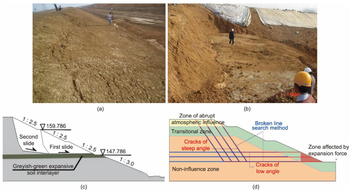
图6. (a) 浅层破坏照片; (b) 深层结构面破坏照片; (c) 深层结构面控制的折线型滑动破坏; (d) 多裂隙不利组合的网格搜索方法。
