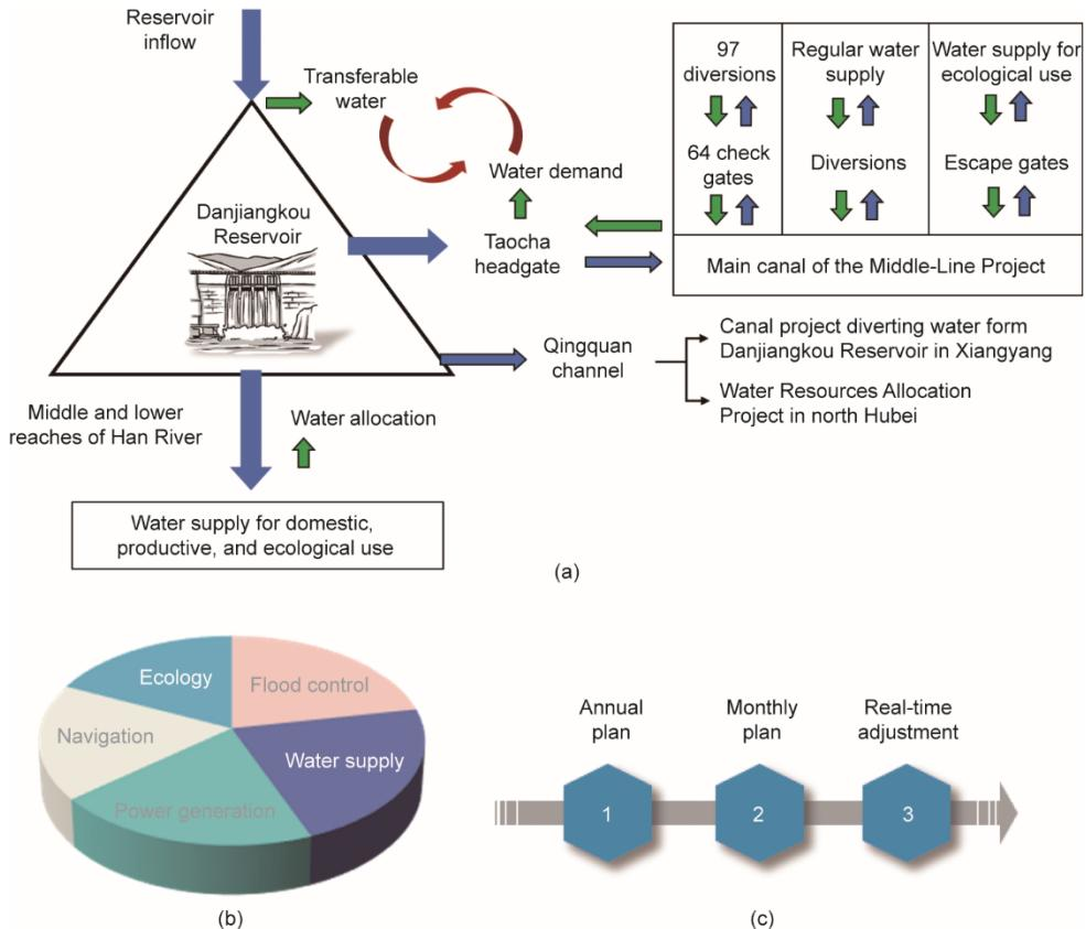
图11. 南水北调中线一期工程全过程精细化动态联合水量调度模型。(a)丹江口水库供水调度示意图;(b)中线工程多目标调度;(c)中线工程“年-月-实时”滚动调度。
