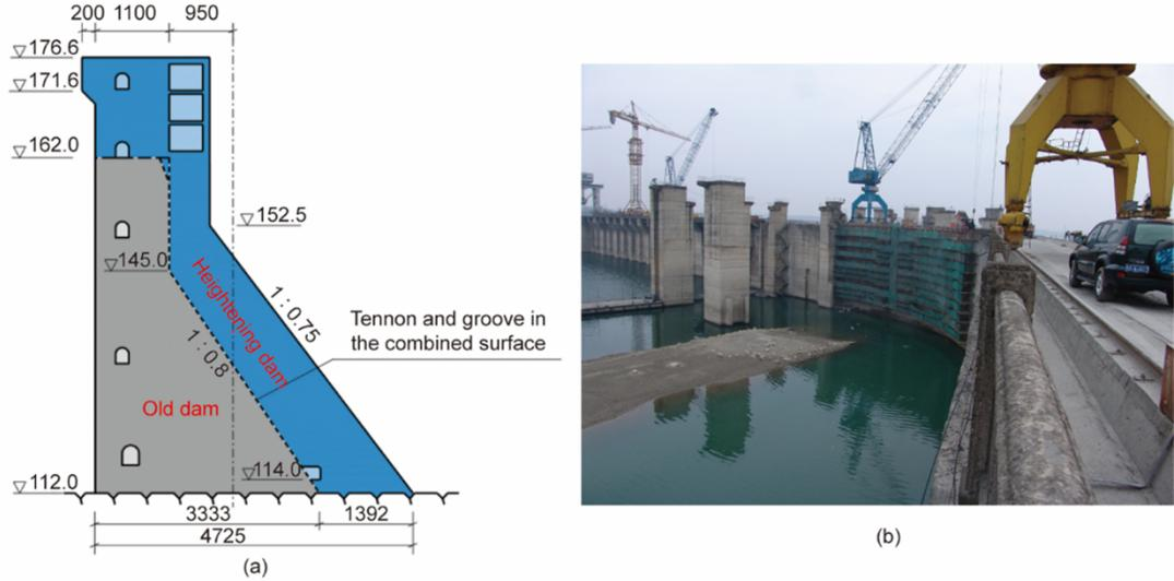
图3. (a) 右联坝段加高方案图; (b) 正常运行条件下的丹江口大坝加高。
