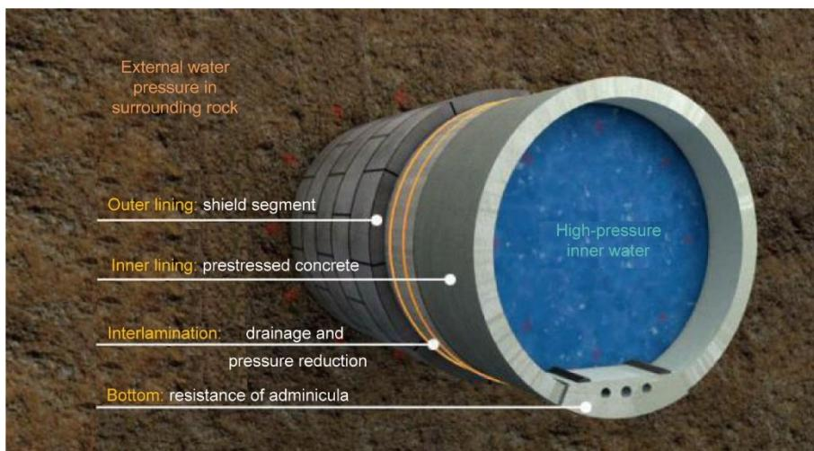
图9. 盾构隧洞预应力复合衬砌结构图。
