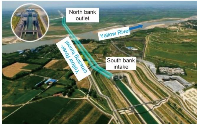
图8. 穿黄隧洞工程布置图。
